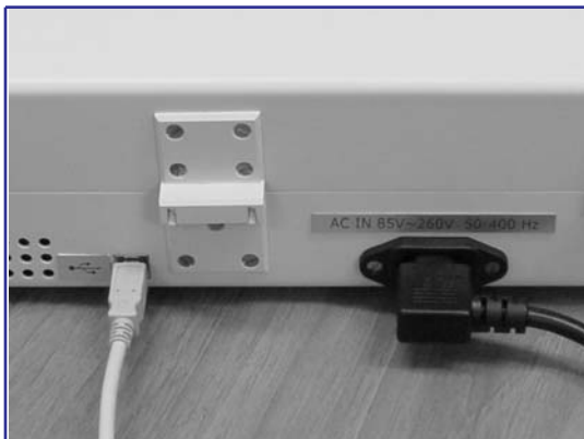
Рисунок 5.2 – соединение прибора проводом USB и проводом питания
